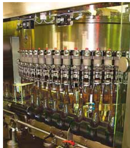
Рис. 1. Автоматическая вакуум-разливная машина Bertolaso EPICA 60/2100
