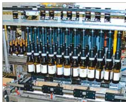
Рис. 7. Автоматические упаковочные машины Emmeti модели Eagle 100/3
