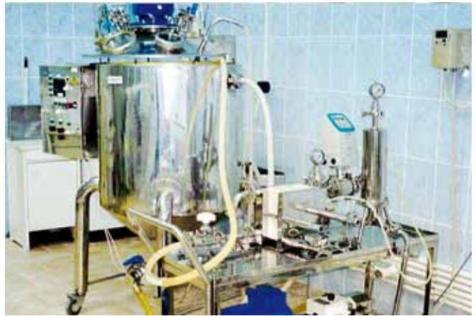
Пилотная установка Кросс-флоу для фильтрации вина на плоских кассетных модулях
