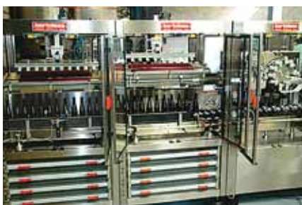
Рис. 3. Ротационная моноблочная машина Bertolaso ZETABLOC 10B/18R
