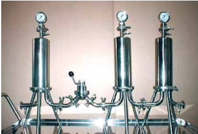
Установка для фильтрации вина на патронных фильтрах перед розливом
