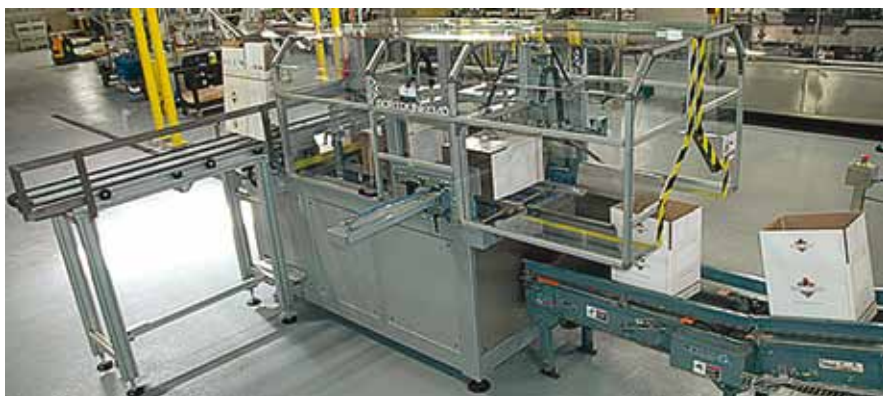
Рис. 5. Машины по формованию коробок Bortolin FOC 23/30 Carton Erectors
