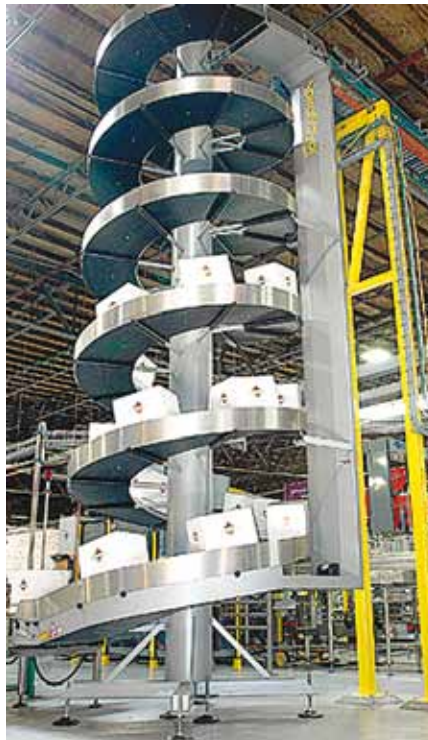
Рис. 9. Спиральный подъемник Alpin
