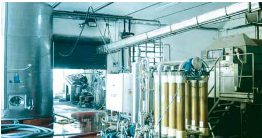
Модульная установка для фильтрации на полых волокнах
