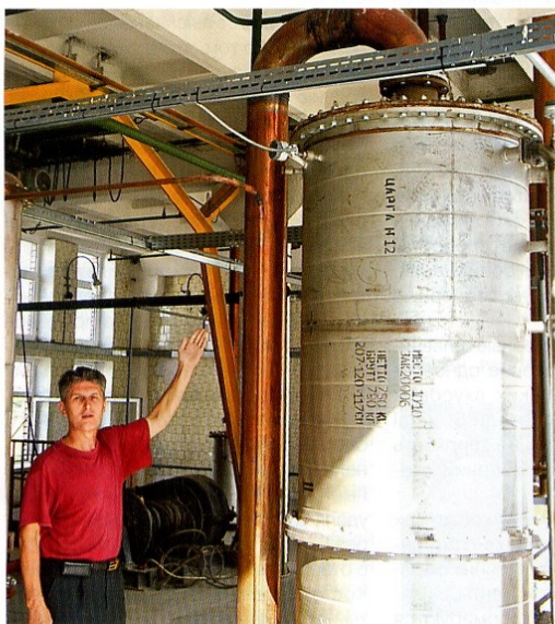
И. М. Гилязетдинов показывает, что пары должны идти не вверх, в дефлегматор, а вниз, в кипятильник
